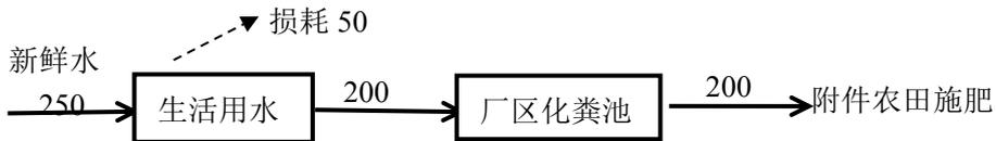
图 2 项目水平衡 单位: t/a
