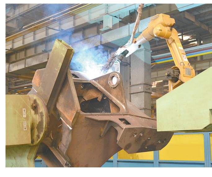
昨日,厦工机械(焦作)有限公司生产车间内的焊接机械手正在作业。为了提高生产效率,该公司加大智能化改造力度,创建关键工序智能机器人加工单元,努力实现“以机代人、人机交互”,提高关键零部件的加工及装配效率,对现有设备进行升级改造。
