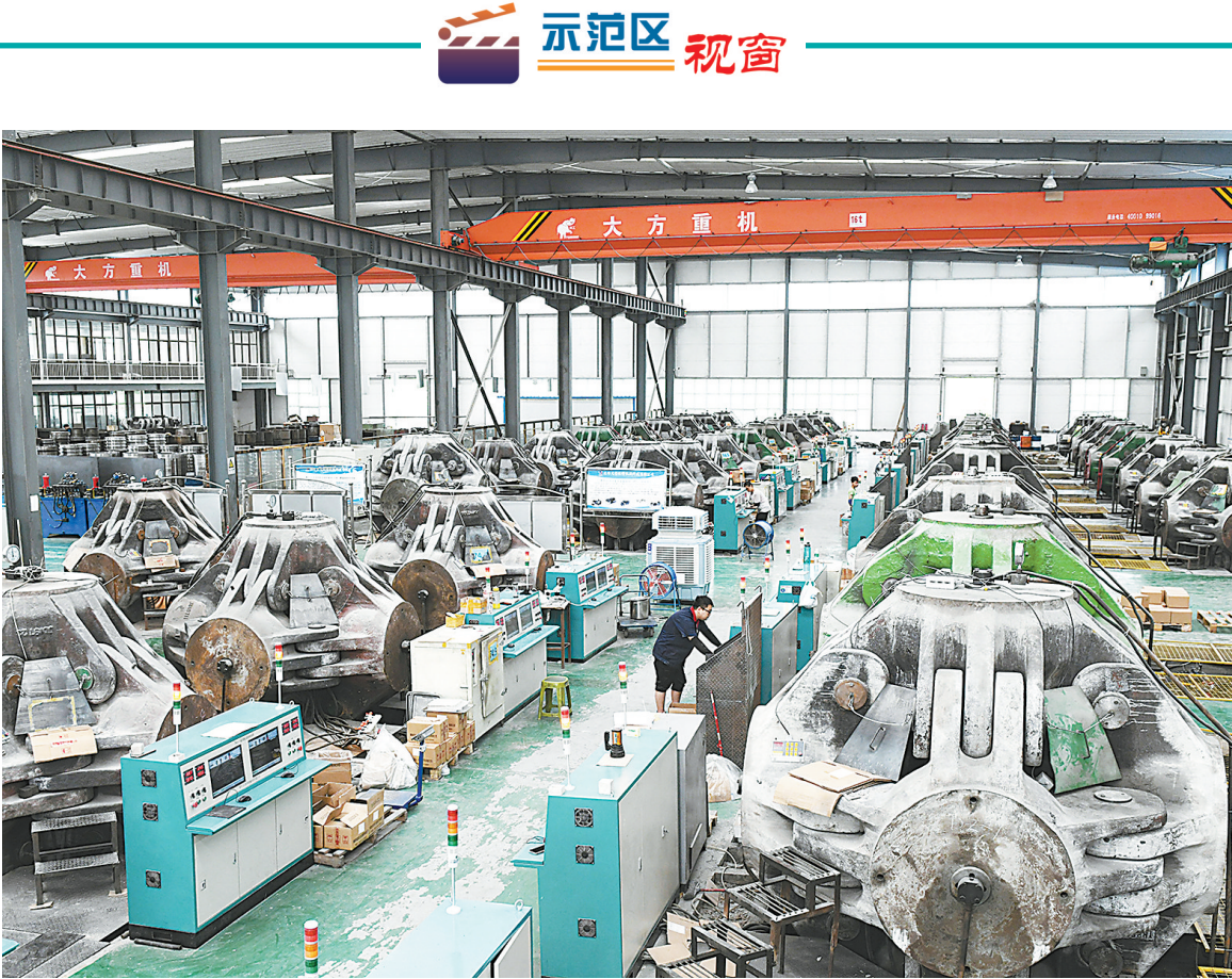
昨日，焦作天宝恒祥机械科技有限公司的工人在生产金刚石超硬材料。 近年来，该公司与阿里巴巴国际站等第三方平台合作，推出产品定制化服务，创新实施了“互联网+电子商务”等营销模式，品牌知名度持续提升，核心产品大缸径六面顶液压机在国际、国内市场占有率分别达40%和43%，稳居行业之首。
