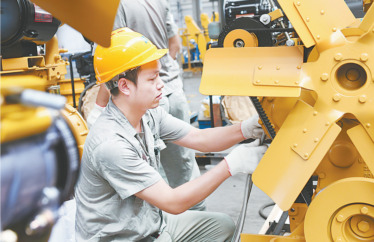
7月31日，厦工机械（焦作）有限公司的工人在组装装载机发动机。今年年初以来，该公司大力开展系列质量技能评价活动，以月度质量积分评比持续提升技能水平和产品质量，产品出厂优质率达100%。 本报记者 刘金元 摄
