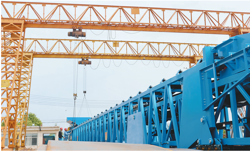
7月27日，焦作市钰欣机械有限公司工人在为客户量身定制的移动装船机组装试机，即将交付海外订单。移动装船机总长约40米，搭配12米的伸缩长度，其灵活伸缩设计可满足不同船舶的舱口位置要求和作业需要，体现了钰欣机械公司的先进技术与精湛工艺。
